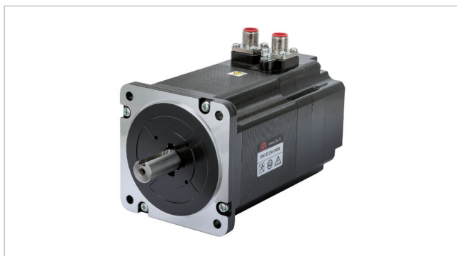
Krokový motor RM3T2M-04D0 s enkodérom 400 imp./ot., IP54
